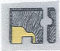
Tagliare il pannello di lana minerale sagomandolo a seconda degli impianti che attraversano il foro muro
